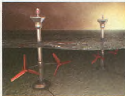
Мал. 275. Турбіни на дні моря, що використовують енергію припливів
