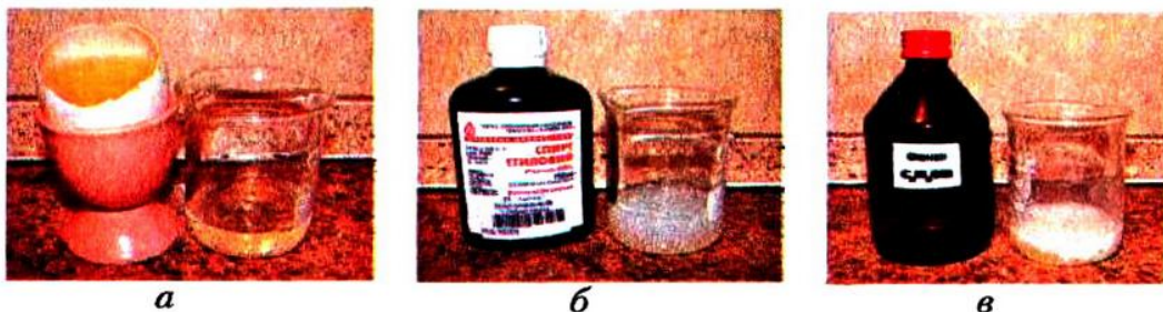
Рис. 22. Розчин білка курячого яйця (а) та денатурація білка під впливом етанолу (б) і фенолу (в)
