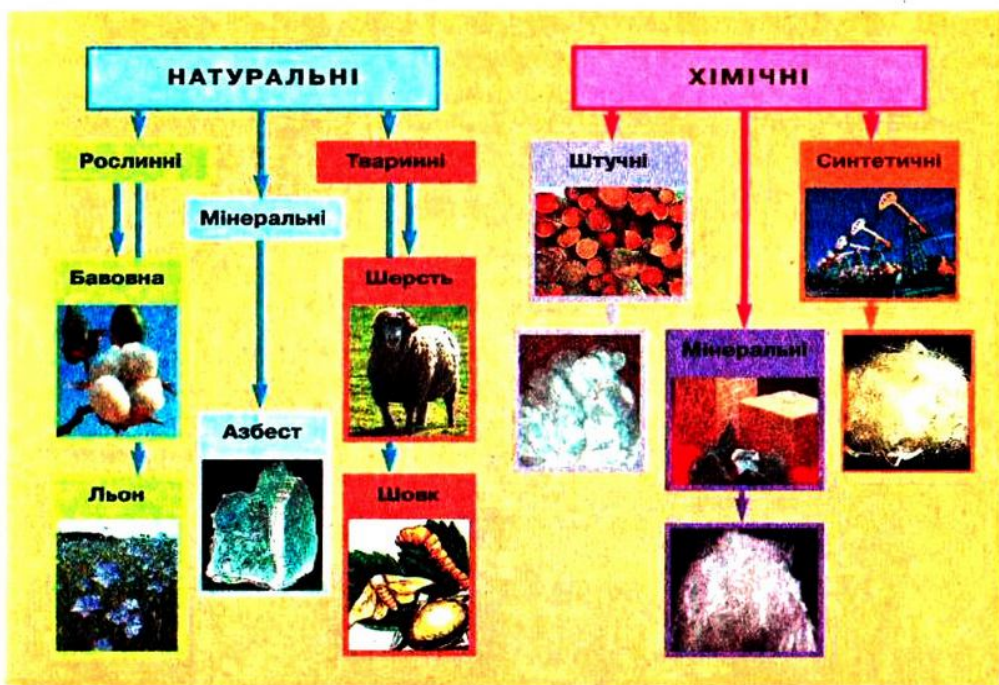
Рис. 72. Схема класифікації текстильних волокон
