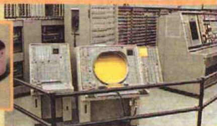
Рис. 2.14. Монітор комп'ютера Whirlwind
