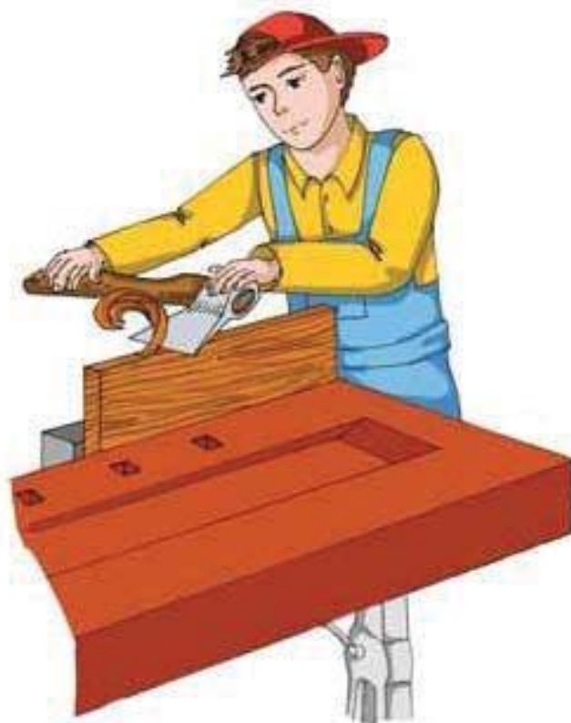
Мал. 39. Сила різання долає опір деревини
