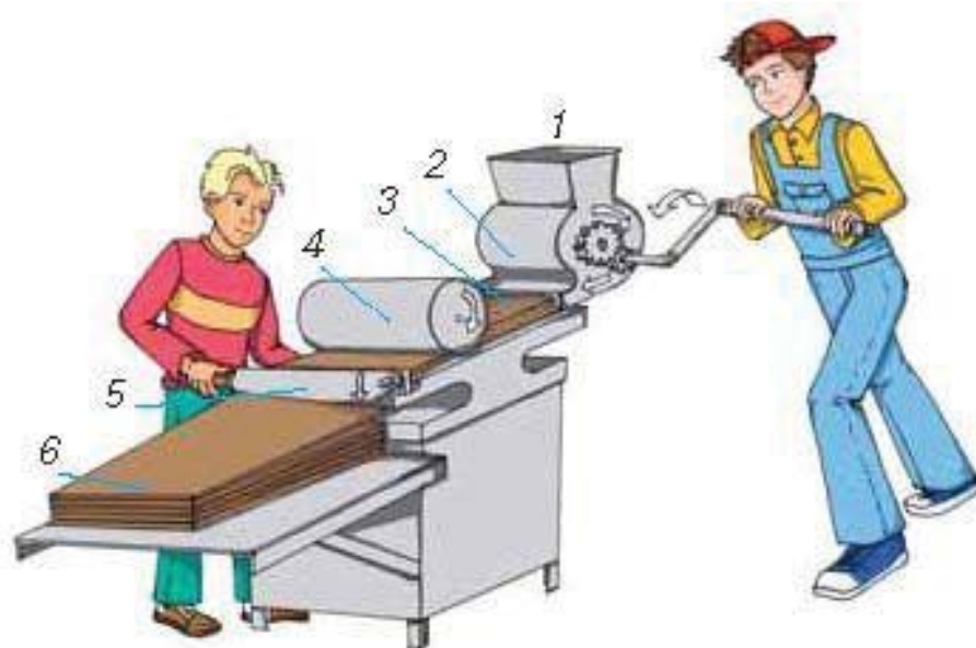
Мал. 14. Спрощена схема виробництва ДВП: 1 — завантажувач тирси і клею; 2 — змішувач; 3 — «килим» із суміші; 4 — прес; 5 — ніж; 6 — листи ДВП
