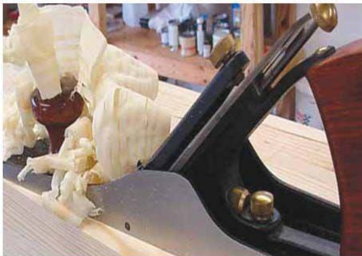
Мал. 152. Утворення стружки під час стругання рубанком
