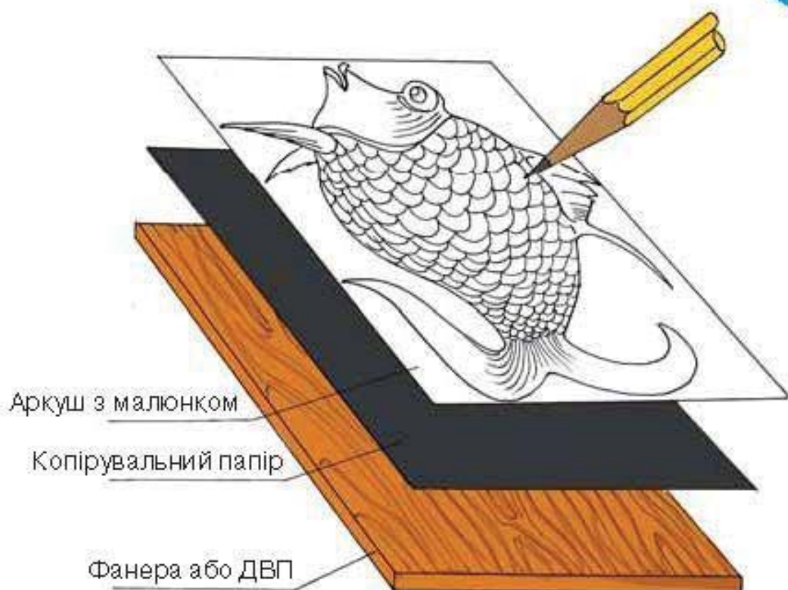
Мал. 99. Перенесення малюнка за допомогою копірувального паперу
