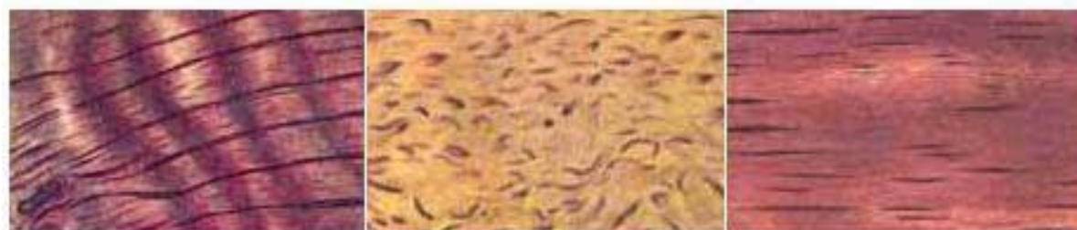
Мал. 10. Текстура деревини різних порід дерев: а — горіха; б — қарельської берези; в — червоного дерева
