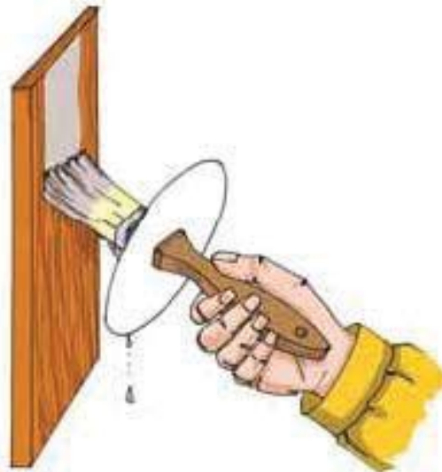
Мал. 91. Картонний диск для захисту рук від клею
