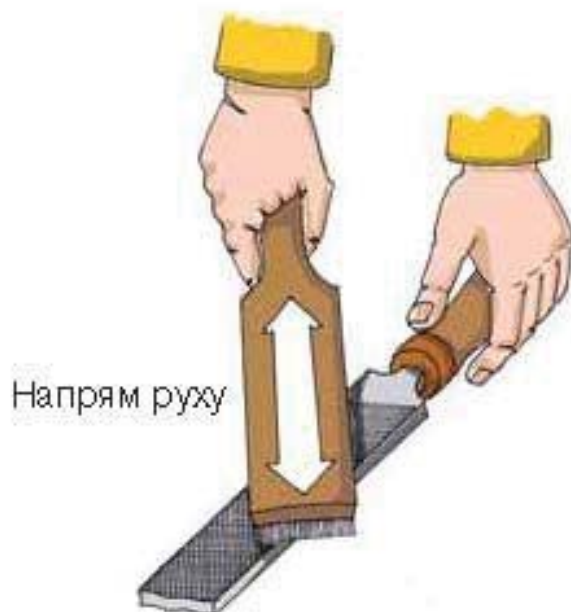
Мал. 78. Очищення рашпіля після виконання робіт за допомогою дротяної щітки
