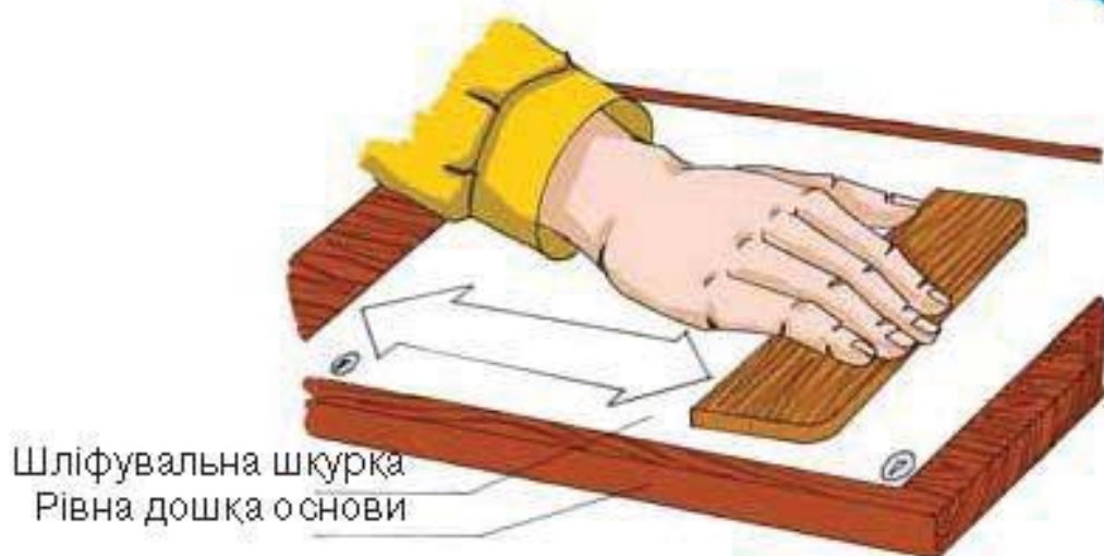
Мал. 77. Прийом шліфування деталей малих розмірів
