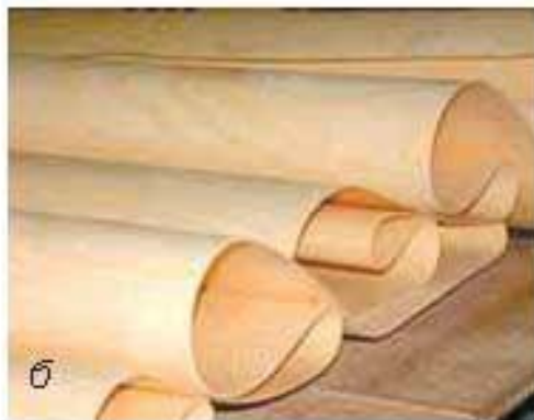
Мал. 12. Виробництво луценого шпону: а — верстат для луцання шпону; 1 — вал верстата; 2 — циліндрична деревинна заготовка; 3 — шар шпону; 4 — спеціальний ніж; б — луцений шпон
