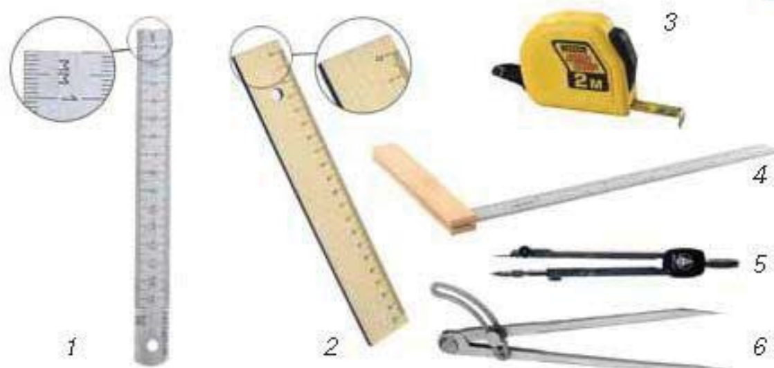
Мал. 29. Вимірювальні та розмічальні інструменти: 1 — металева (слюсарна) лінійка; 2 — дерев'яна лінійка; 3 — рулетка; 4 — кутник; 5 — креслярський циркуль; 6 — розмічальний циркуль
