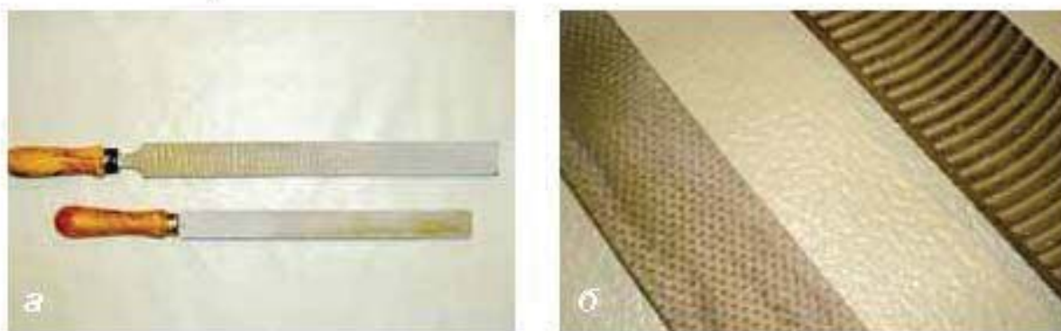
Мал. 70. Плоскі рашпілі: а — загальний вигляд; б — насічки крупно
