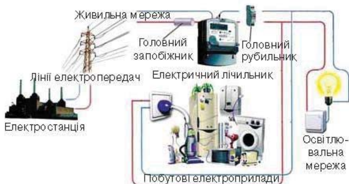
Мал. 169. Спрощений вигляд системи електропостачання
