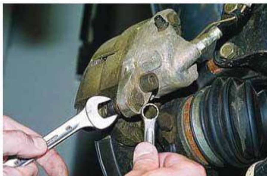
Мал. 129. Використання гайкових ключів
