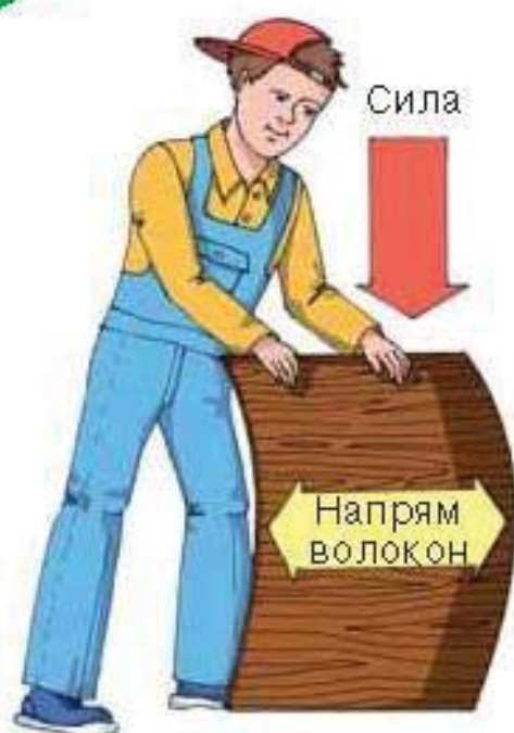
Мал. 21. Напрямок згинального зусилля під час згинання фанери
