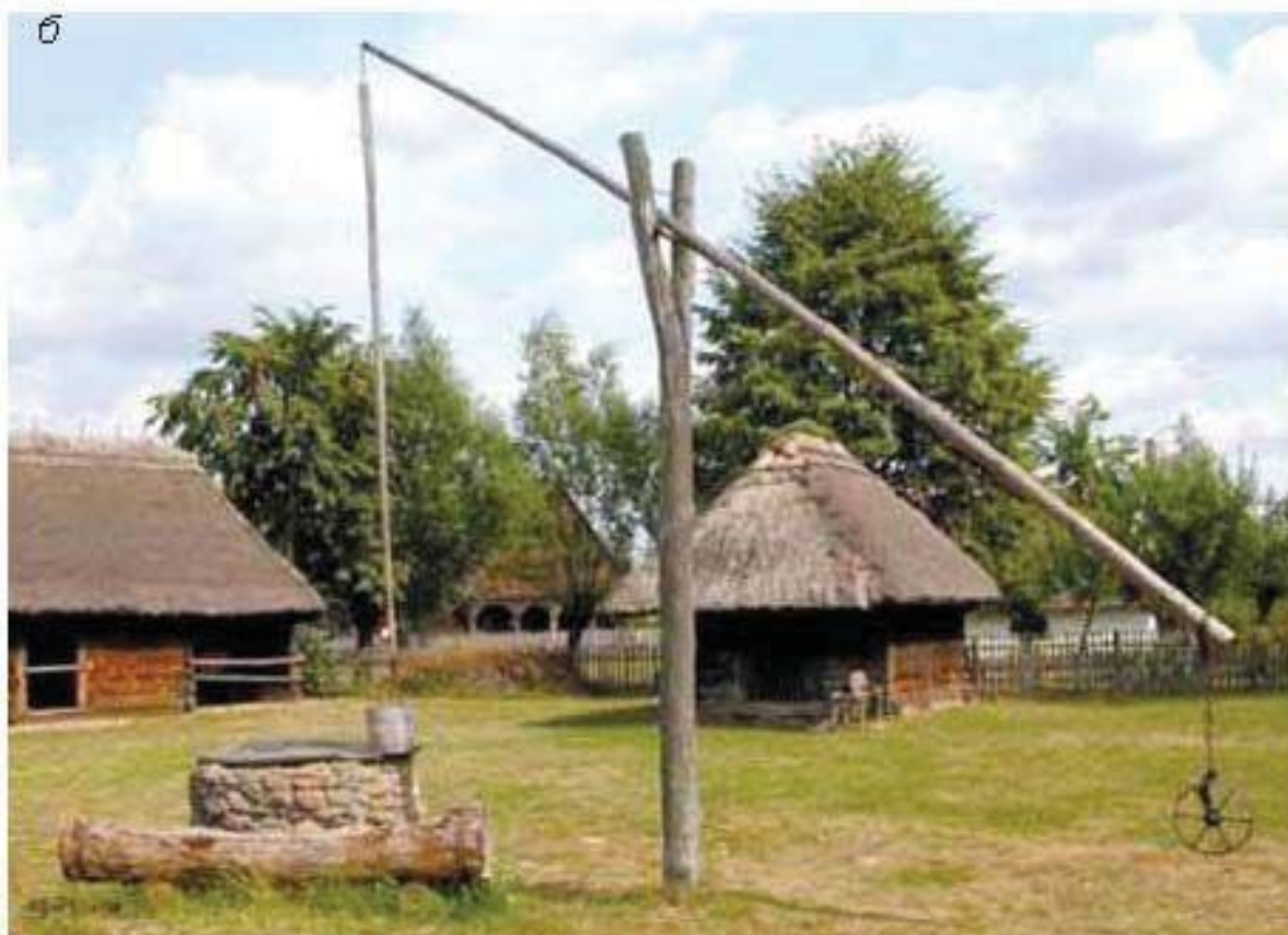
Мал. 119. Використання важеля: а — для піднімання вантажу, б — у конструкції підйомника колодезя
