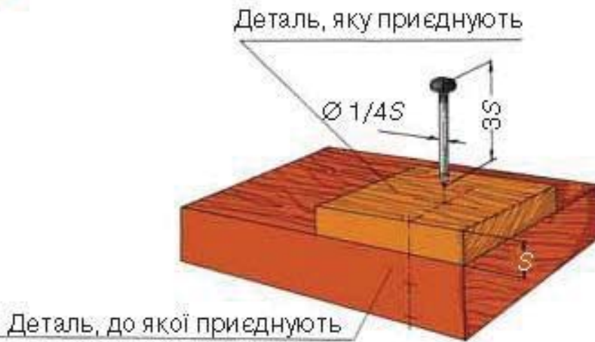
Мал. 83. Вибір діаметра та довжини цвяха залежно від товщини з'єднаних деталей
