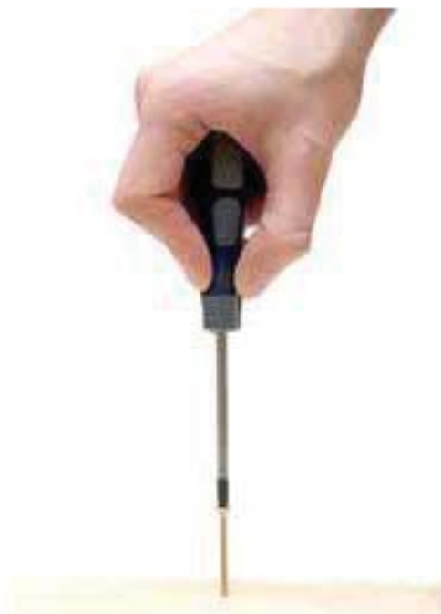
Мал. 128. Вкручування шурупа
