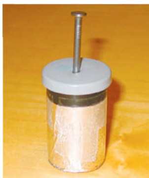
Рис. 33.2. Саморобний конденсатор (модель лейденської банки)
