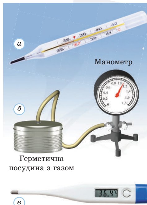
Рис. 22.2. Термометри: a — рідинний; b — газовий; в — електронний
