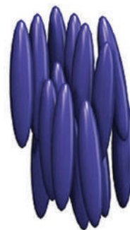
Рис. 25.3. Структура нематичного рідкого кристала
