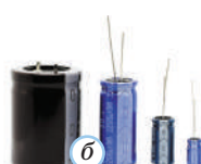
Рис. 33.3. Різні типи конденсаторів: a — полімерні; б — електролітичні; в — керамічні; г — паперовий
