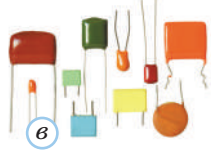
Рис. 33.3. Різні типи конденсаторів: a — полімерні; б — електролітичні; в — керамічні; г — паперовий
