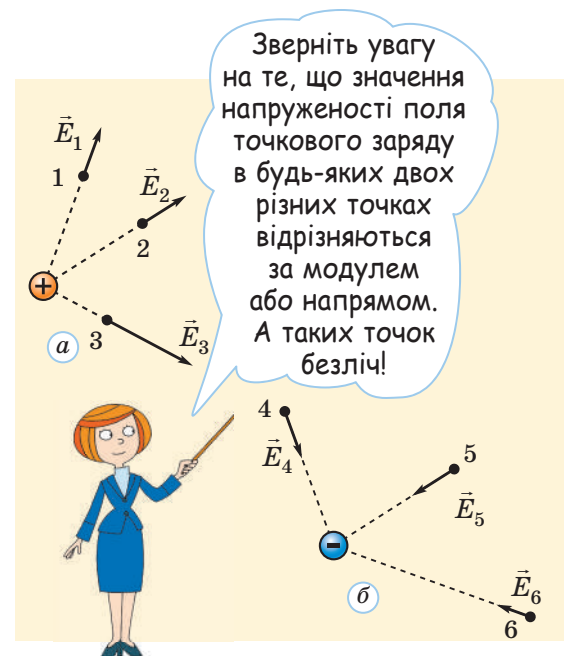
Рис. 30.2. Напруженість електричного поля позитивного точкового заряду в точках 1, 2, 3 напрямлена від цього заряду, а напруженість поля негативного точкового заряду в точках 4, 5, 6 напрямлена до цього заряду. В обох випадках модуль напруженості тим менший, чим далі точка від заряду
