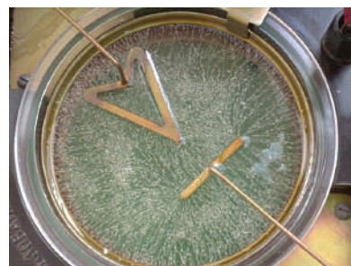
Рис. 31.5. Силові лінії електростатичного поля поблизу провідників
