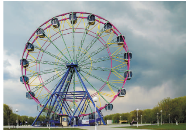
Рис. 11.1. Поступальний рух кабінок колеса огляду: кожна деталь кабінки зберігає свій напрям у просторі під час обертання колеса
