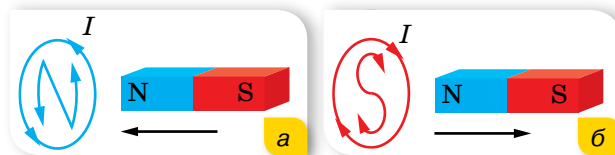
Мал. 92. Визначення напрямку індукційного струму
