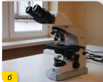
Мал. 202. Хід променів у мікроскопі та його зовнішній вигляд
