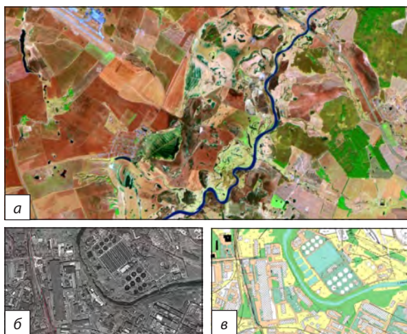
Мал. 4. Аерокосмічні знімки. а) За кольором можна визначити розорані ділянки та такі, де з'явилася рослинність; б) векторизація космічного знімка супутника WorldView-1 (1:5000); в) фрагмент створеної векторної карти (1:5000).
