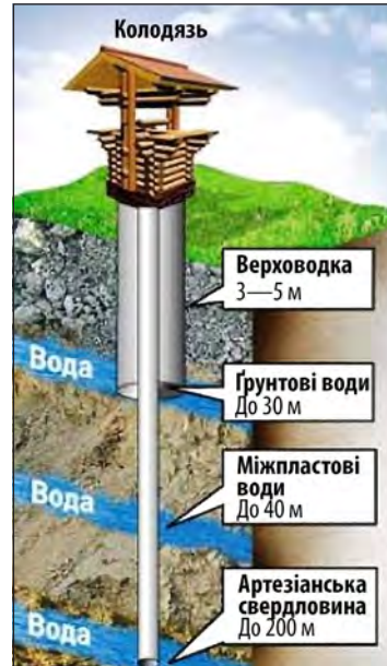
Мал. 2. Розташування підземних вод.
