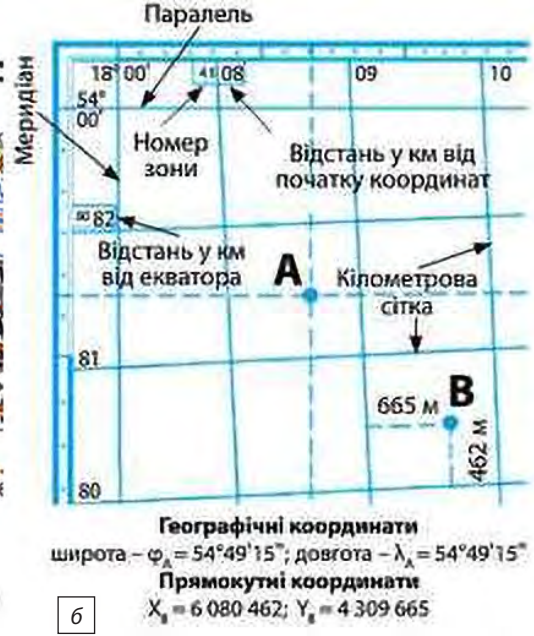
Мал. 3. а) Рамка і кілометрова сітка топографічної карти (1:100 000); б) зразок визначення географічних і прямокутних координат точок за картою.
