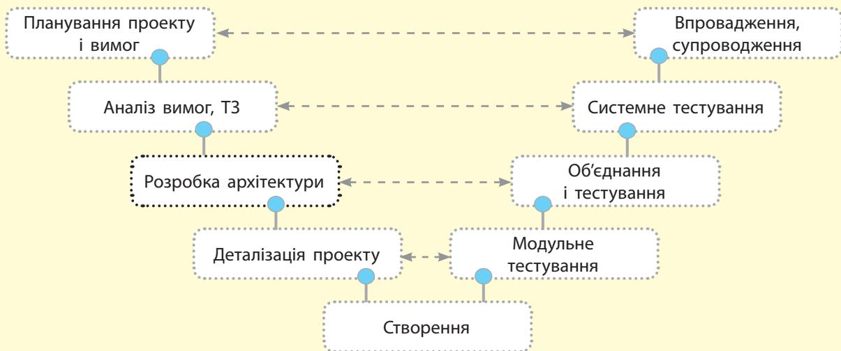
Рис. 12.23. Схема V-моделі
