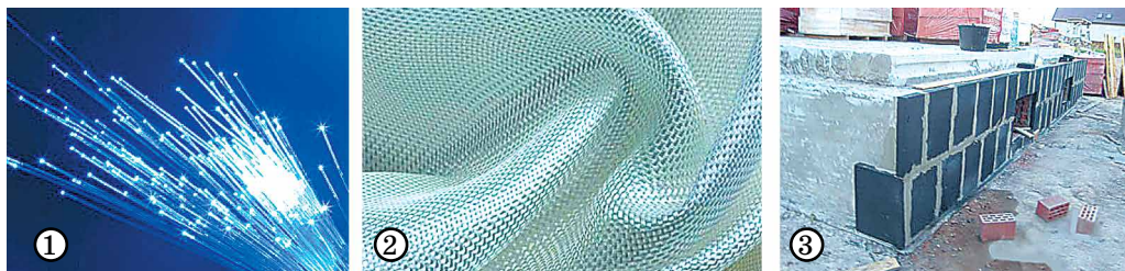
Рис. 29.3. 1. Скляні оптичні волокна виготовляють з кварцового скла. 2. Склотканина – універсальний армувальний, фільтраційний, ізоляційний та будівельний матеріал. 3. Піноскло – легкий пористий формований матеріал, що утворюється внаслідок тверднення спіненої скломаси, – має високі ізоляційні властивості
