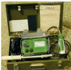
Лл. 69.7. Вимірювач потужності доз ІМД-5
