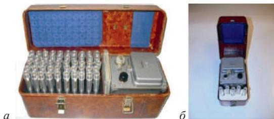
Іл. 70.1 а, б. Комплекти індивідуальних дозиметрів ДП-22В (а) і ДП-24 (б)
