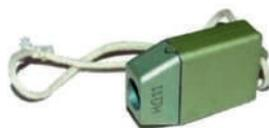
Іл. 70.5. Вимірювач дози індивідуальний ІД-11
