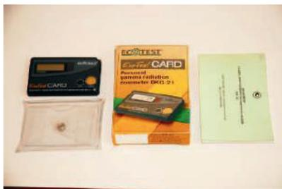
Іл. 70.7. Дозиметр гамма-випромінювання індивідуальний ДКГ-21
