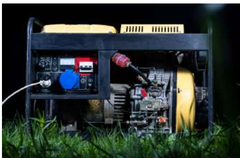
Мал. 5.2. Невеликі дизельні генератори використовують як джерела електричного струму далеко від електромережі
