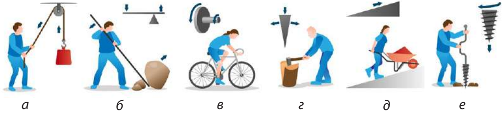
Мал. 17.4. Приклади простих механізмів: блок (а), важіль (б), коловорот (в), клин (г), похила площина (д), гвинт (е)
