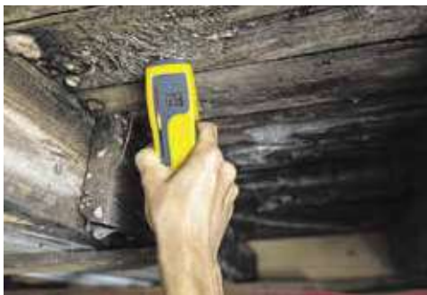
Мал. 4.3. Вимірювання вологості за допомогою вологоміра
