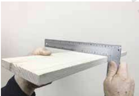
Мал. 6.9. Перевірка стругання площини лінійкою та кутником
