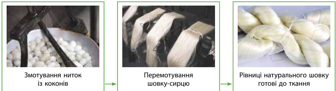
СХЕМА 5. Підготовка шовку-сирцю до ткання
