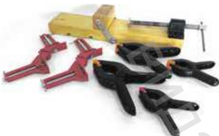
Мал. 7.6. Вайма, кутові та пружинні струбцини
