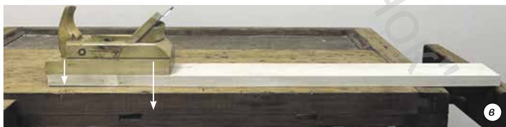
Мал. 6.8. Розподіл зусиль під час стругання
