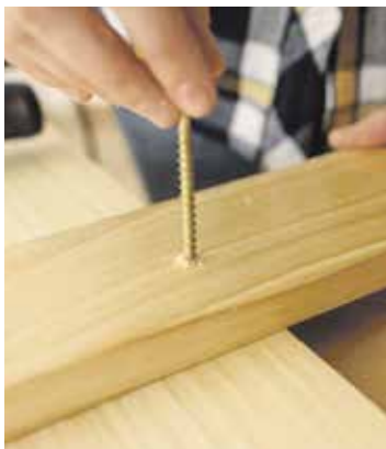
Мал. 4.7. Властивість деревини утримувати цвяхи, шурупи, нагелі — ознака її пружності
