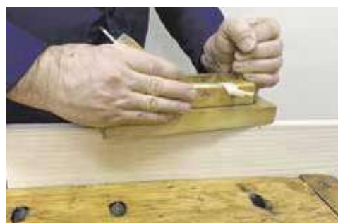
Мал. 6.7. Стругання пластів та крайки
