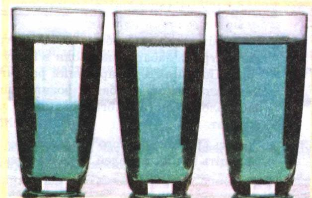
**Рис. 2.16.** Спостереження явища дифузії в рідинах: у результаті дифузії різка межа між розчином мідного купоросу та водою з часом зникає
