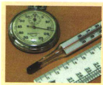
**Тема.** Визначення ціни поділки шкали вимірювального приладу.
