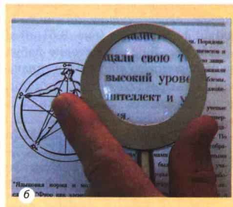
**Рис. 3.63.** а — побудова зображення  $A_1B_1$  предмета у збиральній лінзі: предмет  $AB$  розташований між лінзою та її фокусом; б — за допомогою лупи можна отримати збільшене зображення предмета й розглянути його детальніше
