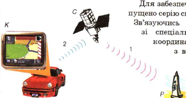
Для забезпечення роботи GPS на орбіту запущено серію спеціальних супутників (рис. 4). Зв'язуючись за допомогою радіохвилі (1) зі спеціальними реперами — точками, координати яких на місцевості відомі з великою точністю, — супутник має можливість визначити й своє місцезнаходження над Землею. Після цього будь-який користувач із допомогою радіохвилі (2) отримує дані про власне місцезнаходження.
