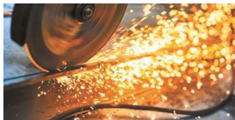
Рис. 12.6. Різання металевого листа за допомогою диска, який обертається з великою швидкістю. Гарячі металеві іскри свідчать про високу температуру в зоні різання
