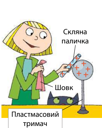
Рис. 28.2. Під час дотику до металеві сфери позитивно зарядженої палички сфера набуває позитивного заряду
