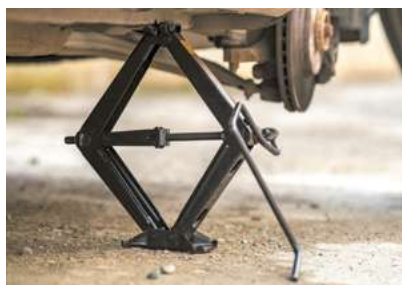
Рис. 1.3. Щоб підняти колесо автомобіля на незначну висоту за допомогою ручного механічного домкрата, людина обертає його ручку, при цьому рука людини долає значну відстань
