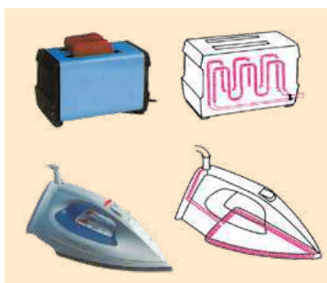
Рис. 42.3. Основна частина будь-якого електричного нагрівального пристрою — нагрівальний елемент
