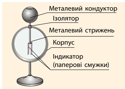
Рис. 29.5. Будова електроскопа. Паперові смужки розташовані вертикально, отже, електроскоп незаряджений
