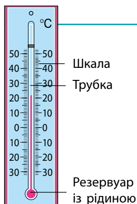
Рис. 10.4. Будова рідинного термометра
