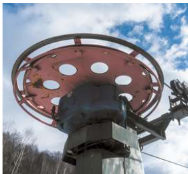
Рис. 3.3. Нерухомі блоки в конструкції кар'єрного екскаватора, у механізмі канатної дороги, а також у складі багатьох інших пристроїв дають змогу змінювати напрямок дії сил під різними кутами
