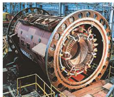
Рис. 33.1. Турбогенератори, що перетворюють механічну енергію обертання турбін на енергію електричного струму, виробляють значну частку споживаної у світі електроенергії
