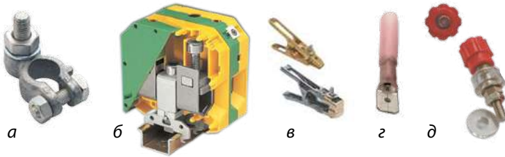
Рис. 34.2. Різні затискачі (кlemi) для з'єднання проводів: акумуляторні (а); високовольтні (б); заземлення (в); ножові (г); приладні (д)
