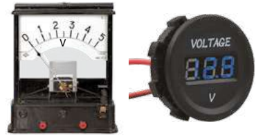
Рис. 36.1. Деякі види вольтметрів: а — демонстраційний; б — цифровий автомобільний
