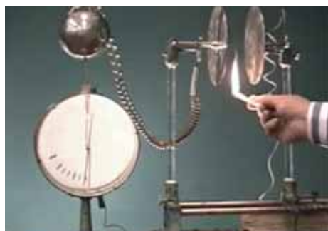
а) б) Рис. 35.1. Дослідження провідності газів
