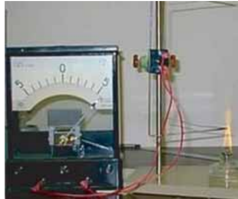
Рис. 24.4. Внутрішня енергія нагрітника перетворюється в електричну
