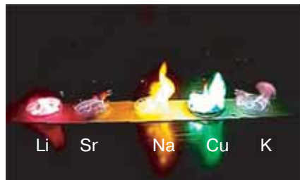
Рис. 14.3. Процес горіння металів у атмосфері кисню
