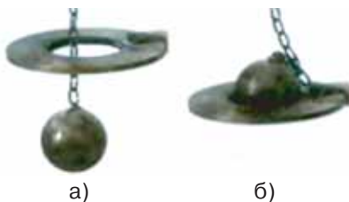
Рис. 4.1. При підвищенні температури тверді тіла розширюються
