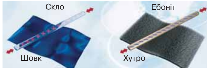
Рис. 18.5. Позитивний заряд утворюється на склі, потертому об шовк, негативний — на ебоніті, потертому об хутро
