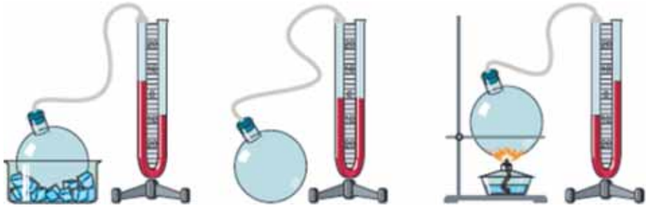
а) б) в) Рис. 4.5. Особливості теплового розширення повітря
