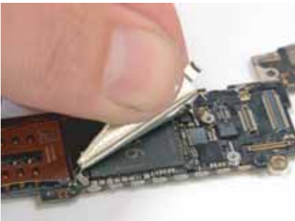
Рис. 21.8. Процесори мобільних пристроїв виготовляють із напівпровідникових матеріалів
