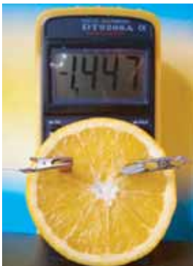
Рис. 24.10. Саморобне хімічне джерело струму
