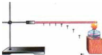
Рис. 6.1. Теплопровідність металевого стрижня
