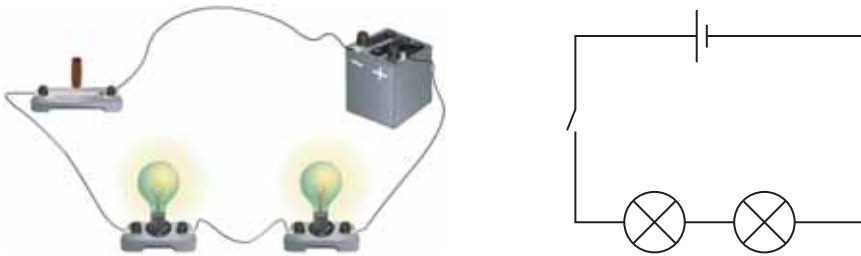
Рис. 29.1. Послідовне з'єднання елементів електричного кола
