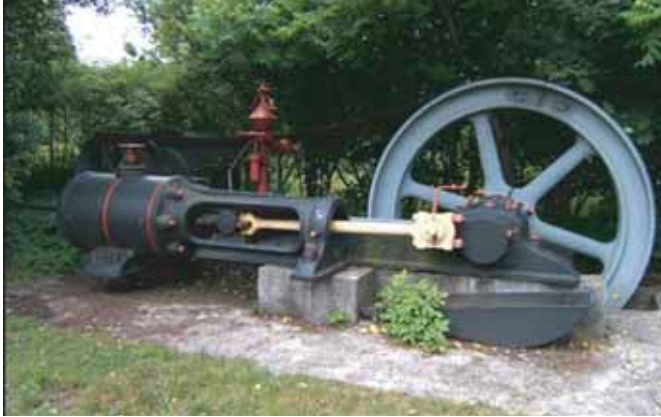
Рис. 16.1. Одна з перших машин із тепловим поршневим двигуном
