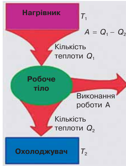
Рис. 15.3. Загальна схема теплової машини С. Карно
