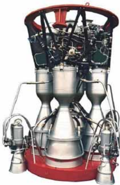
Рис. 16.5. Реактивний двигун РД-108 конструкції В. П. Глушка для ракети-носія Р-7 С. П. Корольова
