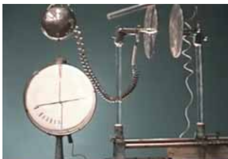
а) б) Рис. 35.1. Дослідження провідності газів
