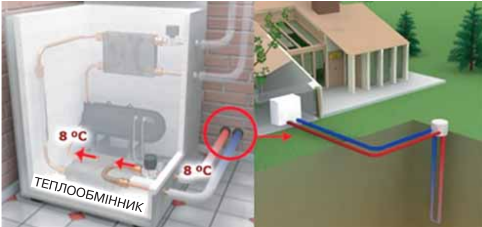
Рис. 17.6. Принцип дії ґрунтового геотермального теплового насосу
