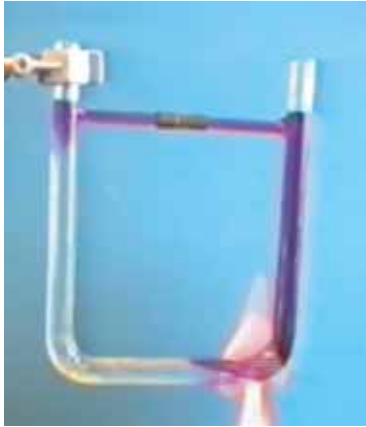
Рис. 6.4. Конвекція в рідині
