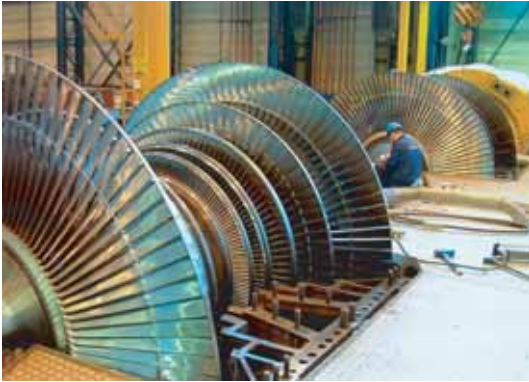
Рис. 16.8. Потужні промислові багаступінчаті турбіни виробництва «Турбоатом» (м. Харків)
