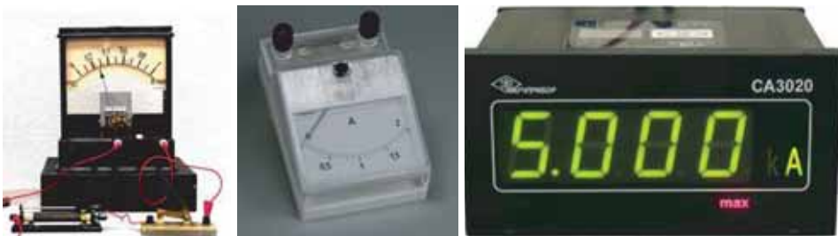
Рис. 25.2. Амперметри: а) демонстраційний; б) лабораторний; в) цифровий
