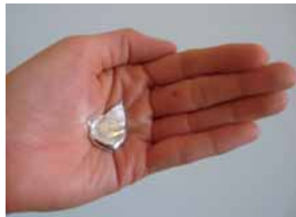
Рис. 10.2. Температура плавлення металу галію становить 29 °С
