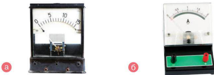
Мал. 24.3. Амперметр: а — демонстраційний; б — лабораторний
