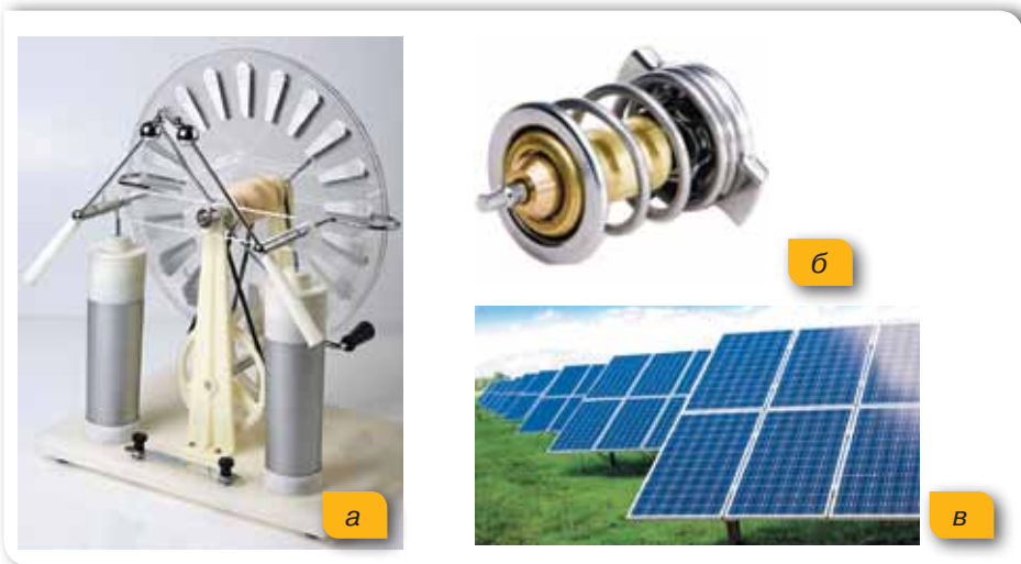
Мал. 115. Інші види джерел струму: а — електрофорна машина, б — термоелемент, в — фотоелемент
