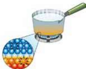
Мал. 29. Механізм теплопровідності
