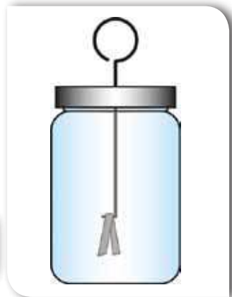
Мал. 102. Саморобний електроскоп
