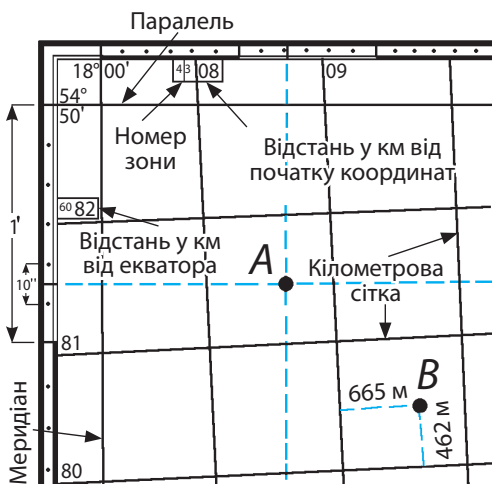
Географічні координати точки А широта – \varphi_A = 54^\circ 49' 15'' ; довгота – \lambda_A = 18^\circ 01' 22'' Прямокутні координати точки В X_B = 6\ 080\ 462 ; Y_B = 4\ 309\ 665
