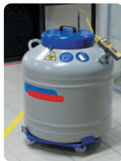
Посудина Дьюара: зовнішній вигляд і загальна схема
