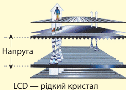
Рис. 3.13. Будова рідкокристалічного монітору
