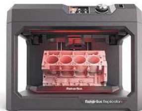
Мал. 2.38. Створення моделі блока циліндрів автомобіля в 3D-принтері
