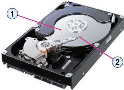
Мал. 2.6. Будова накопичувача на жорстких магнітних дисках
