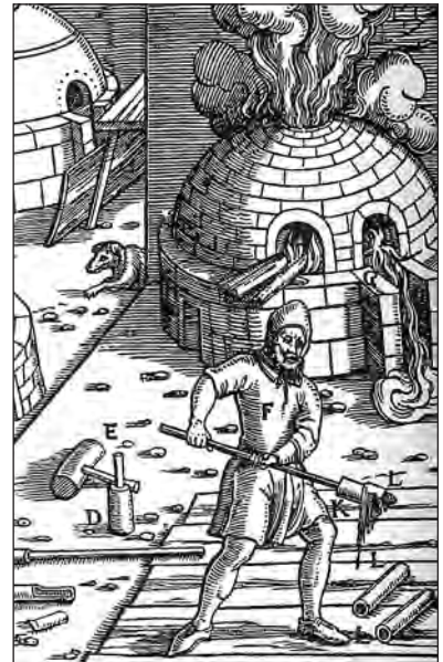
Плавлення руди. Гравюра з книги Г. Агріколи «Про метали». 1556 р.
