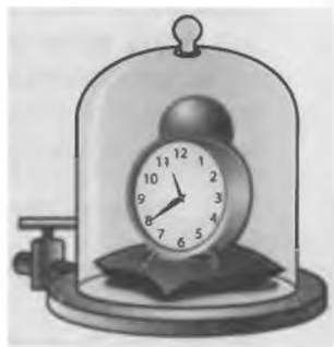
Рис. 7.2. Будильник під ковпаком повітряного насоса
