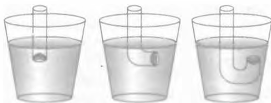
Рис. 18.5. За допомогою по-різному зігнутих трубок з однаковими за діаметром отворами, закритими гумовою плівкою, можна продемонструвати незалежність тиску рідини від напрямку
