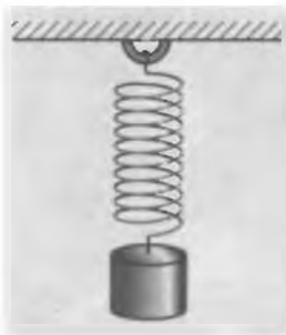
Рис. 6.4. Приклад пружинного маятника: якщо тіло, підвішене на пружині, злегка штовхнути вниз, воно почне коливатися
