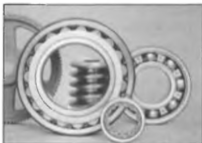
Рис. 14.7. Заміна ковзання на кочення приводить до зменшення сили тертя, і це використовують у кулькових та роликових підшипниках
