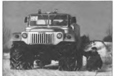
Рис. 17.5. Людина провалилася в сніг, а всюдихід завдяки широким колесам залишився на його поверхні
