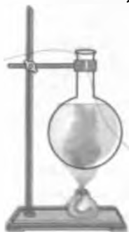
Рис. 37.1. Дослід, що демонструє конвекцію в рідині. Теплі забарвлені струминки води піднімаються, а холодні — опускаються
