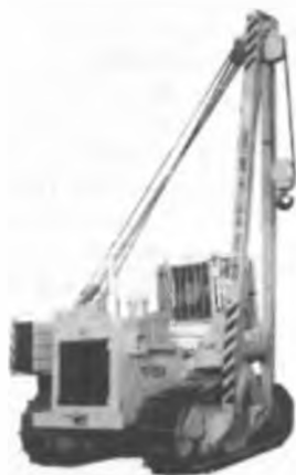
Рис. 31.9. Блоки та важелі легко вгадуються в конструкції трубоукладачів та інших машин
