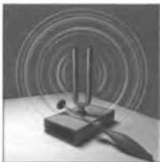
Рис. 8.3. Ніжки камертона коливаються й тому випромінюють звук
