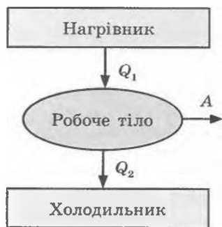
Рис. 42.2. Принцип дії теплових машин: робоче тіло одержує певну кількість теплоти ( Q_1 ) від нагрівника, ця теплота частково перетворюється на механічну енергію (робоче тіло виконує роботу A ), а частково ( Q_2 ) передається холодильнику
