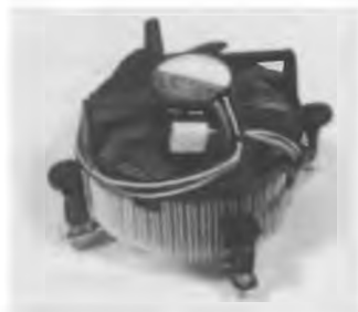
Рис. 5.4. Частота обертання вентиляторів сучасних процесорів становить 50–60 обертів за секунду
