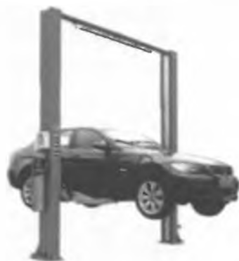
Рис. 22.3. Гідравлічний підйомник — приклад гідравлічної машини
