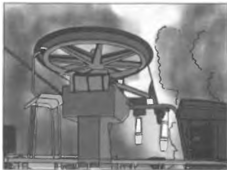
Рис. 16.3. Нерухомий блок у механізмі канатної дороги змінює напрямок дії сили натягу канату на протилежний
