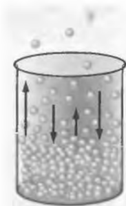
Рис. 46.4. Багато молекул, які залишили рідину, можуть знову повернутися в неї через тепловий рух
