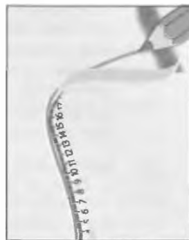
Рис. 1.7. Вимірювання довжини траєкторії руху олівця
