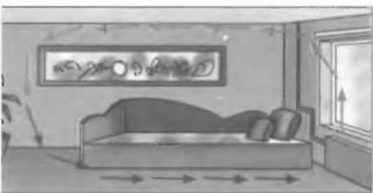
Рис. 37.7. Невеликий тепловий радіатор завдяки конвекції обігрівляє усе приміщення
