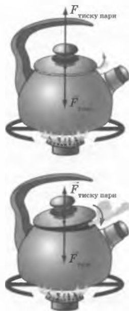
Рис. 42.1. На кришку чайника діють сила тяжіння ( F_{\text{тяж}} = mg ) та сила тиску пари. Якщо F_{\text{тиску пари}} > F_{\text{тяж}} , кришка підстрибує; якщо F_{\text{тиску пари}} < F_{\text{тяж}} , кришка повертається назад
