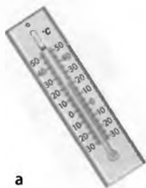
Рис. 33.3. Різні види термометрів: а — рідинний (мірою температури є довжина стовпчика рідини); б — металевий (біметалічна пластинка, яка з'єднана зі стрілкою термометра, вигинається в результаті нагрівання); в — термометр опору (зі зміною температури змінюється сила електричного струму в колі); г — медичний (унаслідок зміни температури змінюється колір відповідної ділянки термометра)
