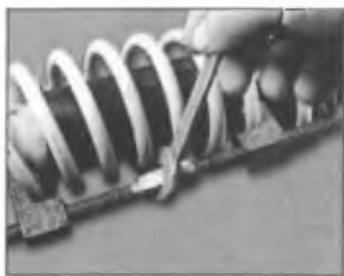
Рис. 13.3. Стискаючи пружину, ми деформуємо її. При цьому в пружині виникає сила пружності
