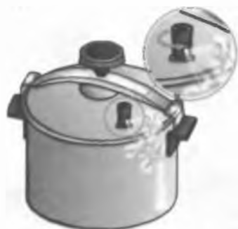
Рис. 47.5. Каструля-скороварка: завдяки клапанам та герметичній кришці в просторі над рідиною підтримується високий тиск, тому температура кипіння води в такій каструлі сягає 200^{\circ}\text{C}
