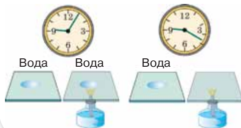
Мал. 57. Швидкість випаровування залежить від температури
