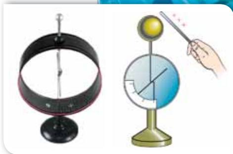
Мал. 100. Електрометр: а — зовнішній вигляд; б — принцип дії
