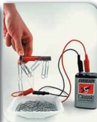
Мал. 121. Магнітна дія струму
