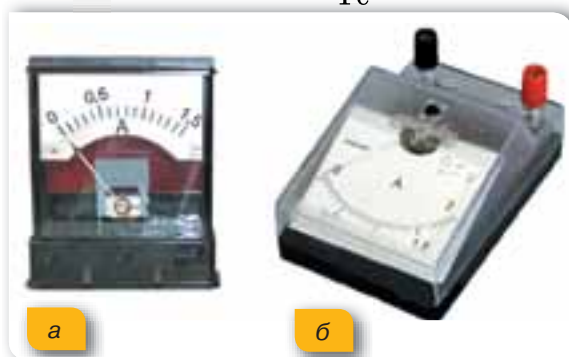
Мал. 144. Амперметр: а — демонстраційний; б — лабораторний
