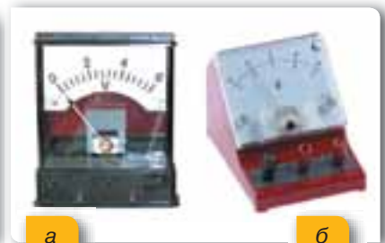
Мал. 148. Вольтметр: а — демонстраційний; б — лабораторний
