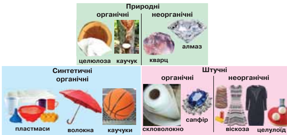
Мал. 81. Класифікація полімерів та полімерних матеріалів
