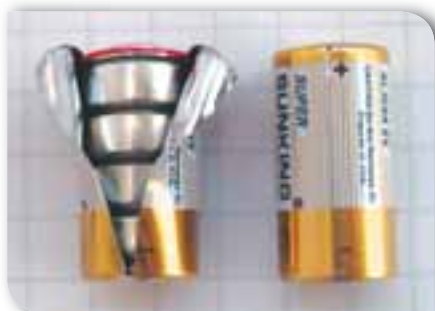
Мал. 128. Батареї: а — акумуляторна; б — гальванічних елементів
