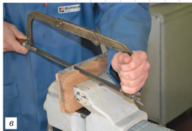
Рис. 6.6. Прийоми роботи ножівкою
