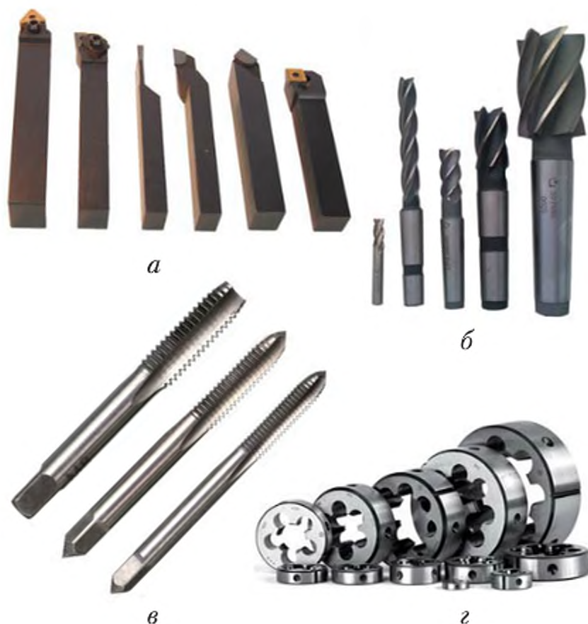
Рис. 11.5. Найбільш застосовувані інструменти для токарної обробки, які встановлюють на верстаті: а – різці; б – фрези; в – мітчики; г – плашки
