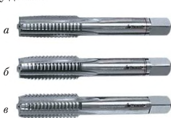
Рис. 10.6. Комплект мітчиків: а – чорновий; б – середній; в – чистовий
