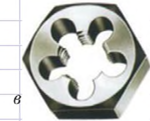
Рис. 10.2. Плашки: a – суцільна кругла; б – розрізна кругла; в – суцільна шестикутна
