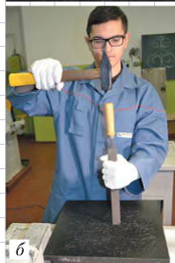
Рис. 8.7. Кріплення ручки напилка на хвостовику: а – правильно; б – неправильно
