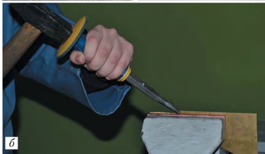
Рис. 7.5. Рубання металу: а – на плиті; б, в – у лещатах; з – хватка молотка
