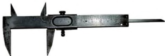
Англійський Columbus, від якого пішла назва «колумбіки» для всіх штангенциркулів цього типу
