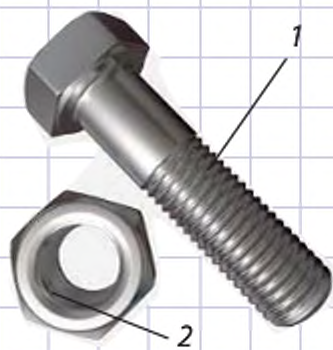
Рис. 9.4. Різьба: 1 – зовнішня; 2 – внутрішня
