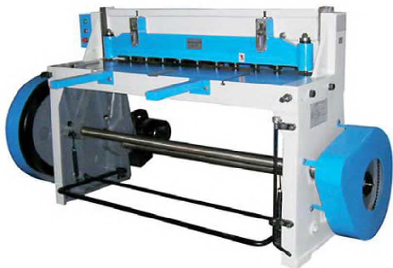
Рис. 6.7. Гільйотинні ножиці з електромеханічним приводом
