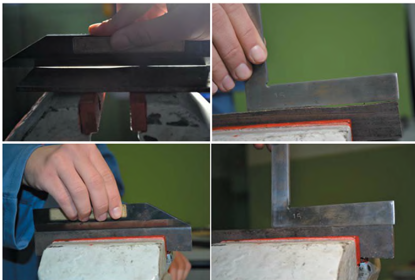
Рис. 8.10. Перевірка якості обпилювання
