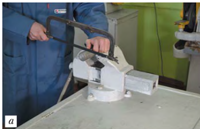
Рис. 6.6. Прийоми роботи ножівкою
