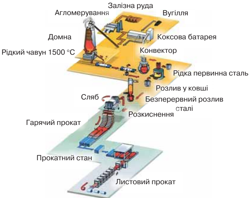
Мал. 69. Від чавуну до готового прокату
