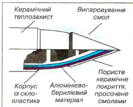
Мал. 33. Схема будови стінки головного блоку космічного корабля
