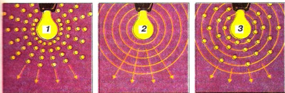
Мал. 66. Моделі поширення світла: 1 — за уявленнями Ньютона (корпускулами); 2 — за уявленнями Гюйгенса (хвилями); 3 — за сучасними уявленнями
