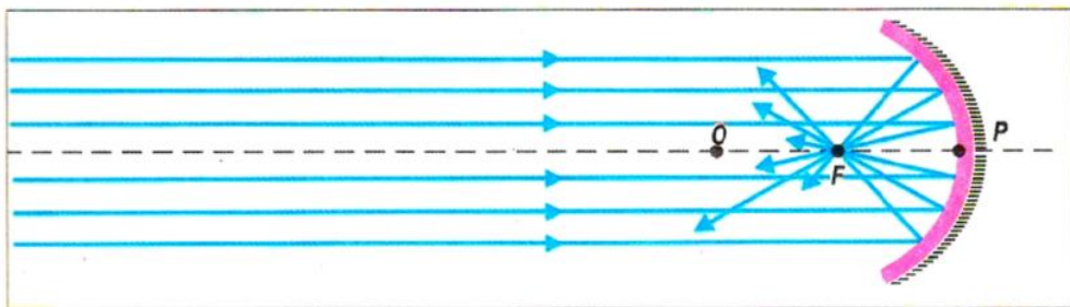
Мал. 84. Хід променів у вгнутому дзеркалі: O — центр кривизни дзеркала; F — фокус дзеркала; P — вершина дзеркала
