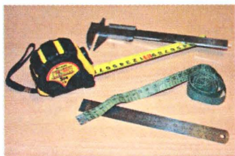
Мал. 12. Для вимірювання лінійних розмірів застосовують лінійки, рулетки, мірні стрічки тощо
