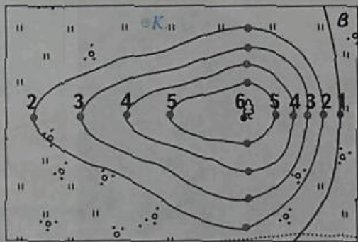
Мал. 52. Вимірювання відносної висоти горба нівеліром та зображення його на плані місцевості
