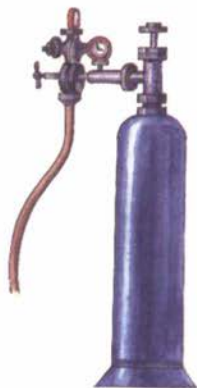
Мал. 45. Балон для збереження та транспортування газоподібного кисню
