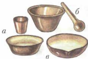
Мал. 18. Порцеляновий посуд: а – чашка і тигель; б – ступка з товкачем; в – чашка для випаровання
