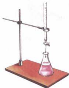
Мал. 20. Використання штативу для збирання нескладних приладів
