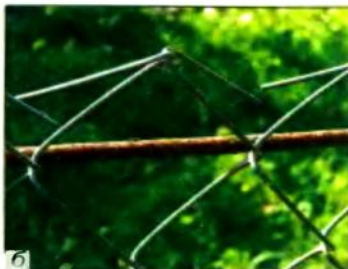
Мал. 69. Корозія заліза: а — бочка, яку «з'їла» іржа; б — іржавий дріт, на якому закріплено оцинковану залізну сітку
