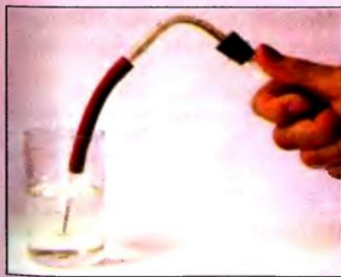
Мал. 60. Перевірка приладу на герметичність
