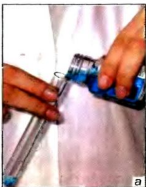
Мал. 14. Переливання рідини: а — із баночки в пробірку; б — за допомогою скляної палички; в — із однієї пробірки в іншу
