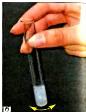
Мал. 13. Перемішування рідини: а — скляною паличкою; б — струшуванням
