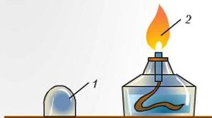
Рис. 23. Горіння спиртівки: 1 – ковпачок; 2 – полум'я
