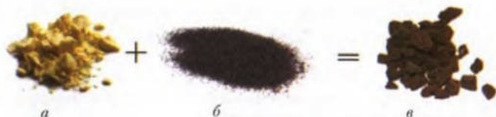
Рис. 51. Схема утворення ферум(II) сульфїду: а — сірка; б — залізо; в — ферум(II) сульфід
