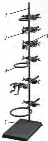
Рис. 19. Будова лабораторного штатива:
