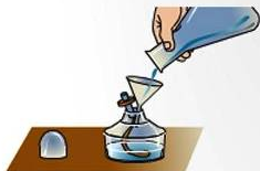
Рис. 22. Правильний спосіб заливання спирту в спиртівку
