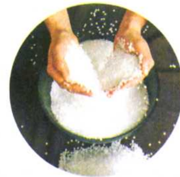
Мал. 48. Промисловий поліетилен випускають у вигляді гранул (крихти)
