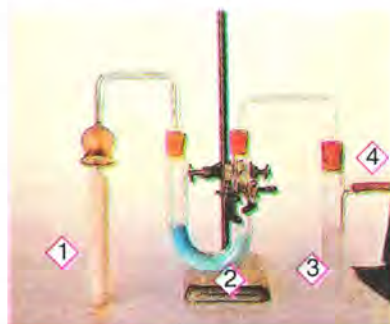
Мал. 22.2. Визначення якісного складу парафіну (суміші гомологів метану) за продуктами згоряння. 1. Запалена парафінова свічка. 2. Безводний купрум(II) сульфат. 3. Розчин кальцій гідроксиду (вапняна вода). 4. Аспіратор (відсмоктувач повітря)
