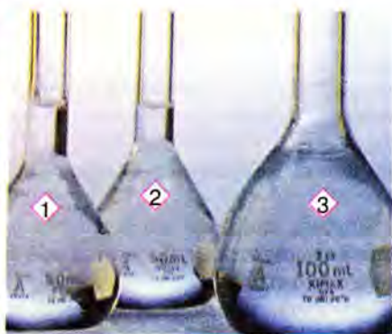
Мал. 5.5. 1. Вода об'ємом 50 мл. 2. Етиловий спирт об'ємом 50 мл. 3. Об'єм водного розчину етилового спирту менший, порівняно із сумою об'ємів цих рідин до змішування
