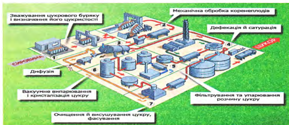
Мал. 32.5. Загальна схема виробництва цукру
