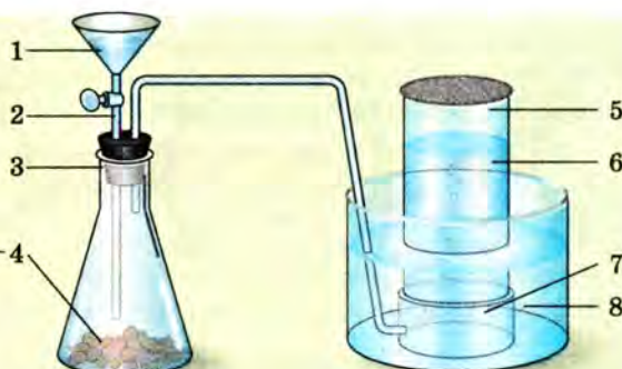
Мал. 26.4. Добування ацетилену й збирання його витісненням води.
