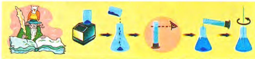
Мал. 2. Послідовність виготовлення розчину певної маси із заданою масовою часткою розчиненої речовини
