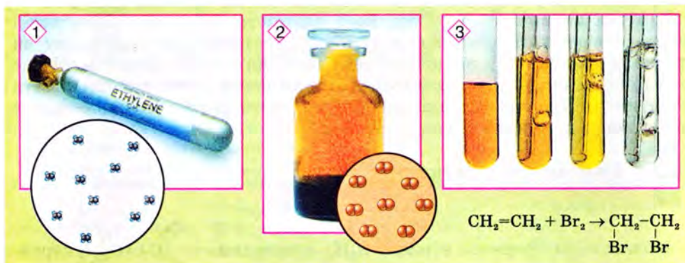
Мал. 24.7. Реактив на етилен (1) та його гомологи – бромна вода (2). Насичений водний розчин брому поступово знебарвлюється (3) внаслідок пропускання крізь нього етилену
