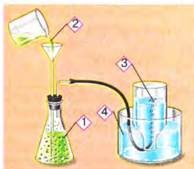
Мал. 13.4. Взаємодія алюмінію (1) з хлоридною кислотою (2). Водень (3) збирають у посудину витісненням води (4)
