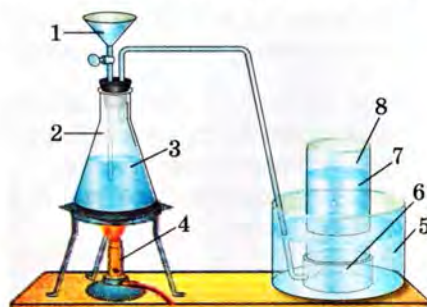
Мал. 24.4. Добування етилену з етилового (винного) спирту. 1. Лійка. 2. Термостійка колба. 3. Суміш етилового спирту з концентрованою сульфатною кислотою, подрібнена порцеляною (кип'ятильники). 4. Пальник. 5. Вода. 6. Підставка. 7. Мірний циліндр. 8. Етилен
