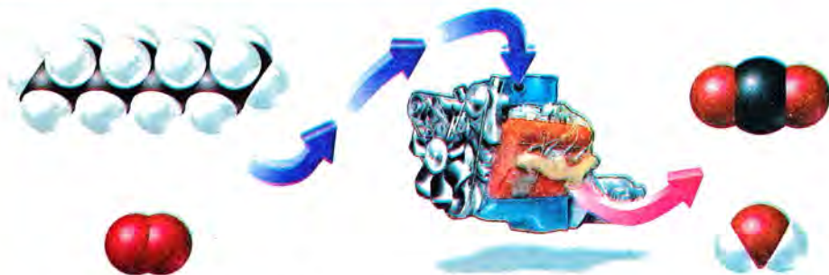
Мал. 23.8. Схематичне зображення реакції повного окиснення октану у двигуні внутрішнього згоряння
