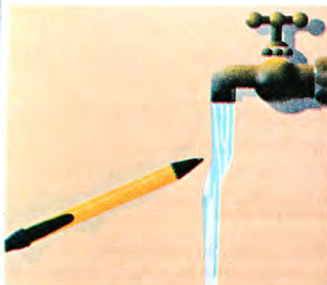
Мал. 4.3. Молекули води полярні: тонка водяна цівка притягується до пластмасових виробів, наелектризованих тертям
