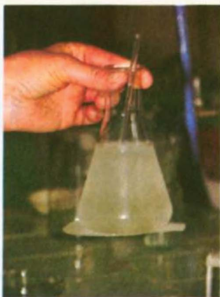
Мал. 22. Вбирання теплоти під час розчинення \text{NH}_4\text{NO}_3 у воді
