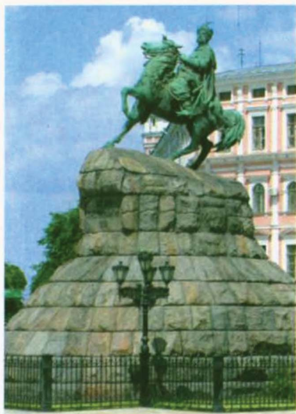
Мал. 57. Богдан Хмельницький. Бронзовий пам'ятник у вологому повітрі покривається зеленим нальотом основного купрум(II) карбонату \text{Cu}_2(\text{OH})_2\text{CO}_3
