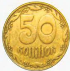
Мал. 15. Матеріал, з якого зроблена монета (твердий розчин), — суміш міді, нікелю та алюмінію
