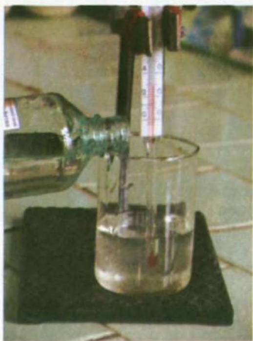
Мал. 23. Виділення теплоти під час розчинення \text{H}_2\text{SO}_4 у воді
