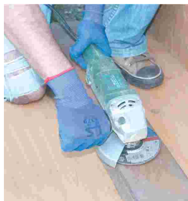
Мал. 154. Очищення від іржі електрифікованим інструментом
