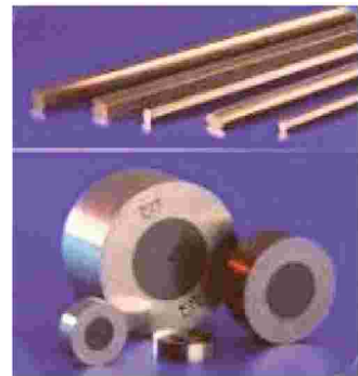
Мал. 33. Профілі дроту, виготовленого волочінням
