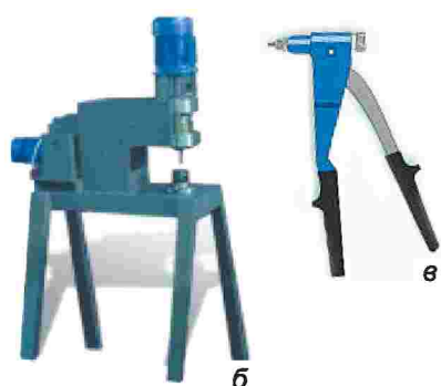
Мал. 126. Інструменти для клепа́ння: а – пневматичний клепа́льний молоток; б – електромеханічна клепа́льна машина; в – ручний заклепочник
