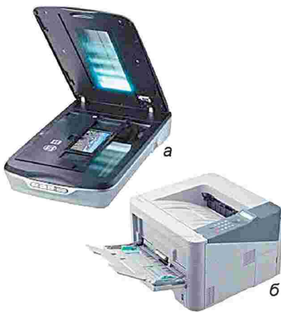
Мал. 208. Пристрої для роботи з інформацією в електронному вигляді: а – сканер; б – принтер
