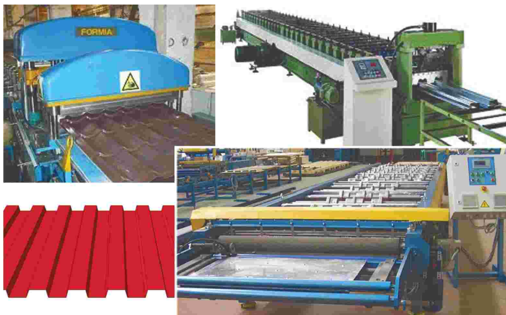
Мал. 17. Формування листового металу з різним профілем на прокатному стані
