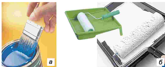
Мал. 166. Підготовка інструментів для нанесення фарби: а – флейцем; б – валиком
