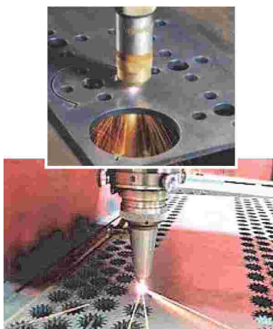
Мал. 84. Різання металу лазером
