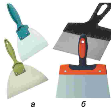
Мал. 162. Види шпателів: а – гумовий; б – металевий
