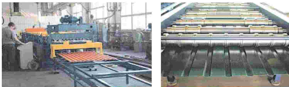
Мал. 111. Гнуття металу на профілезгинальному стані
