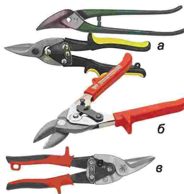
Мал. 70. Типи ножиць: а – прямолінійні; б – фігурні; в – універсальні
