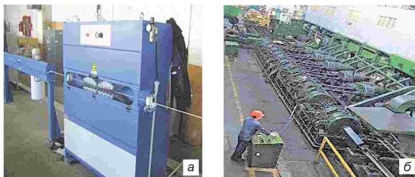
Мал. 36. Автоматична (а) та напівавтоматична (б) лінії виробництва дроту
