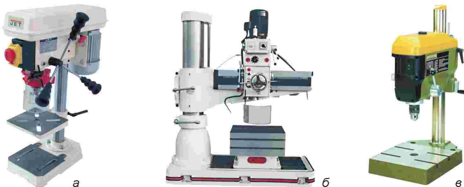
Мал. 206. Промислові свердлильні верстати: а – вертикально-свердлильний; б – радіально-свердлильний; в – настільний свердлильний
