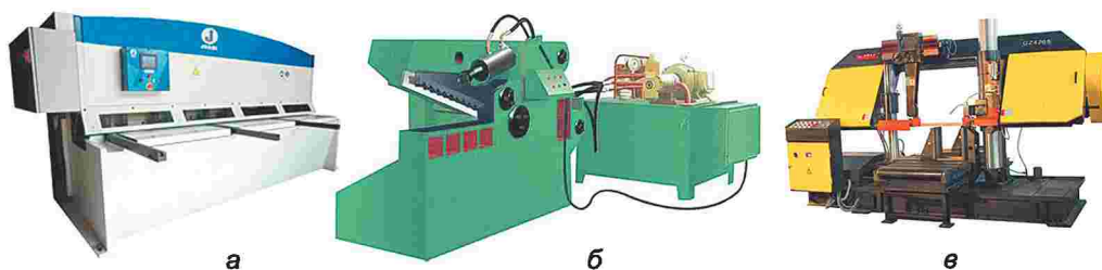
Мал. 81. Види машинних ножиць: а – гільйотинні; б – гідравлічні (алігаторні); в – дискові
