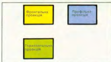
Мал. 13. Розміщення трьох проекцій деталі на площині
