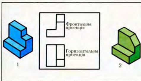
Мал. 9. Невизначеність форми предмета за двома проєкціями
