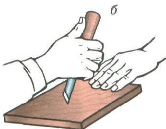
Мал. 90. Положення різачка під час різання: а – «до себе»; б – «від себе»
