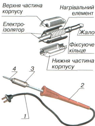
Мал. 155. Конструкція електричного паяльника:
