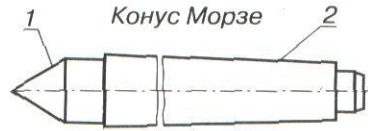
Мал. 111. Звичайний (жорсткий) центр: 1 – робочий конус; 2 – хвостовик
