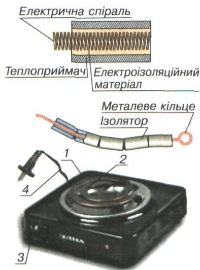
Мал. 151. Конструкція електричної плитки із закритим нагрівальним елементом: 1 – металева основа; 2 – корпус нагрівального елемента; 3 – регулятор напруги; 4 – електричний шнур
