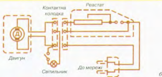
Мал. 38. Швейна машина з електричним приводом: а — загальний вигляд; б — спрощена електрична схема електроприводу ДПС-2
