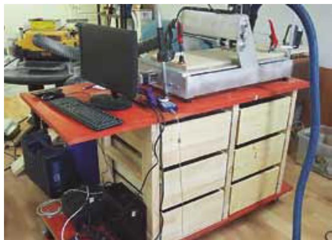
Мал. 153. Настільний лазерний апарат
