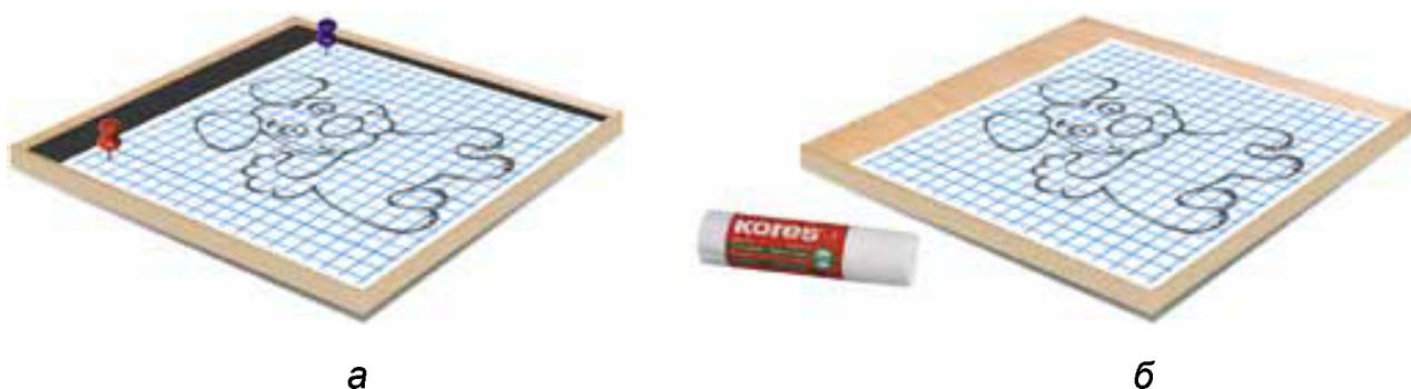
Мал. 44. Кріплення малюнка на заготовці: а – канцелярськими кнопками; б – клейовим олівцем
