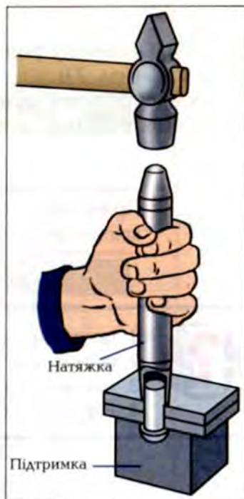
Мал. 75. Застосування натяжки і підтримки
