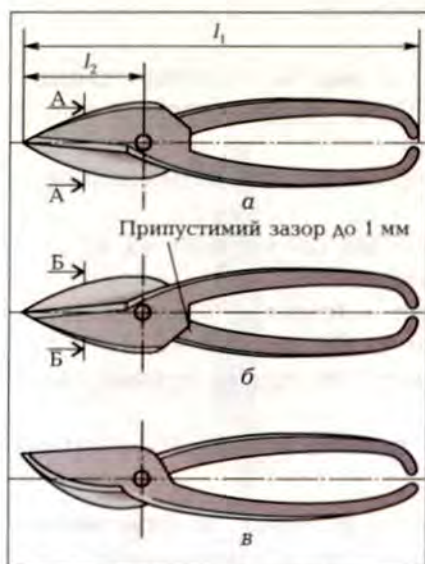
Мал. 47. Слюсарні ножиці: а — прями ліві; б — прями праві; в — для фігурного різання
