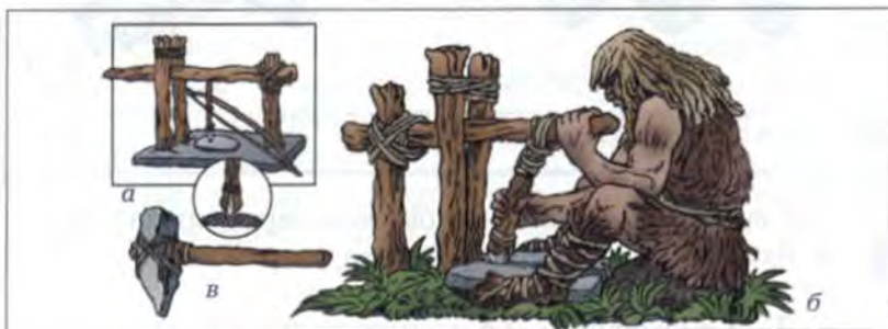
Мал. 36. а — пристрій для свердління у камені за допомогою лука; б — пристрій для вистругування канавок у камені; в — важке кам'яне зубило з ручкою, вставленою в просвердлений у камені отвір
