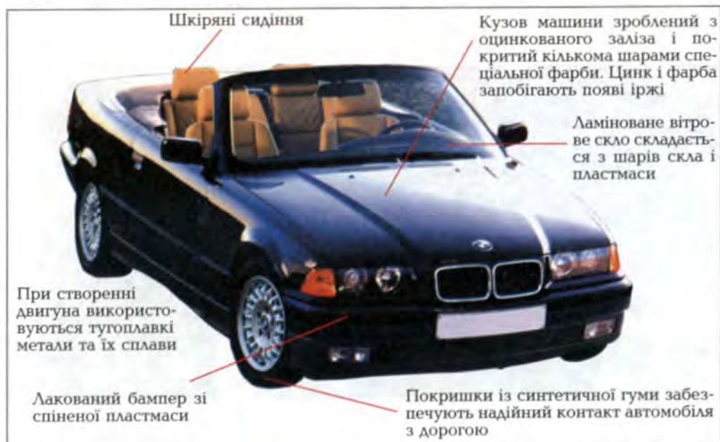
Мал. 6. Матеріали, з яких виготовлено автомобіль
