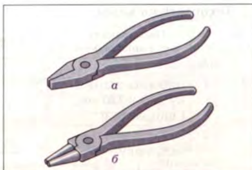
Мал. 93. Інструменти для гнуття дроту: а — плоскогубці; б — круглогубці
