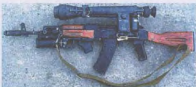
Іл. 12.12. АК-74 у комплекті з підствольним гранатометом та прицілом нічного бачення
